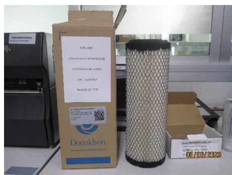
ภาพที่ 2.2-3 อะไหล่สำหรับอุปกรณ์ในระบบตรวจวัดคุณภาพอากาศแบบต่อเนื่อง (CEMS)
