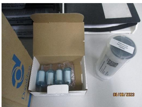
ภาพที่ 2.2-3 อะไหล่สำหรับอุปกรณ์ในระบบตรวจวัดคุณภาพอากาศแบบต่อเนื่อง (CEMS)
